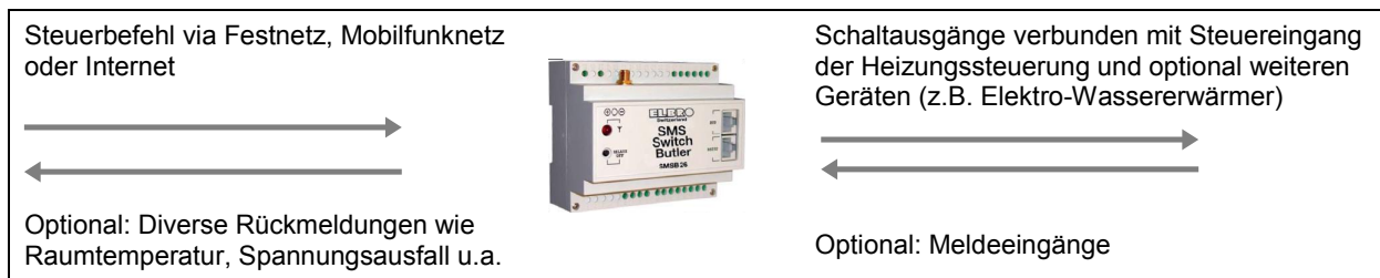
Figur 3: Typischerweise werden zum Fernsteuern der Heizung universelle Fernsteuergeräte eingesetzt
