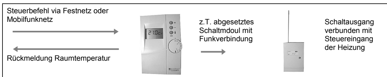
Figur 4: Drei der 20 Produkte sind Fernsteuergeräte mit Raumthermostat und Schaltausgang
