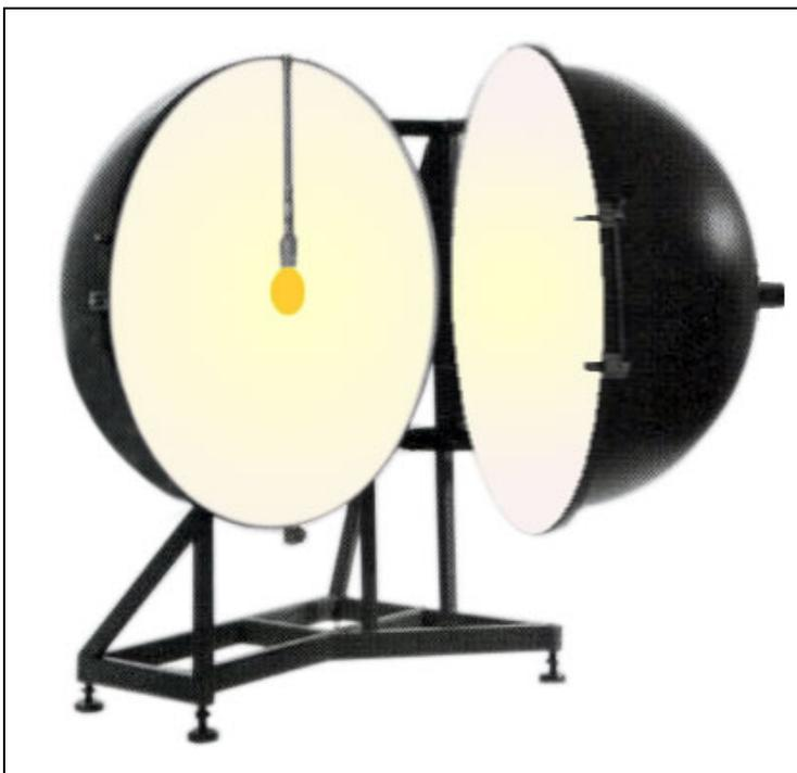
**Abbildung 1: In der Ulbricht'schen Kugel werden Lichtstrom und Aufstartzeit gemessen**
